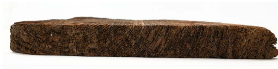
Figura 3. Cara inferior de la puerta en la que se aprecia la curvatura de los anillos de crecimiento del pino, lo que permite identificar que la madera fue cortada siguiendo la sección tangencial.
